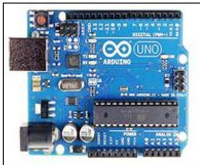
**Figura 1** – Módulo Arduino Uno. Fonte: Acervo da Internet
