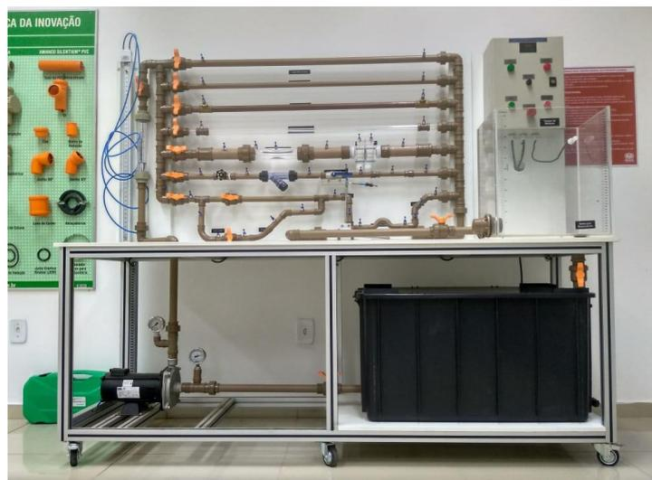
Figura 1 – Bancada Didática para estuda de mecânica dos fluidos e bombas
